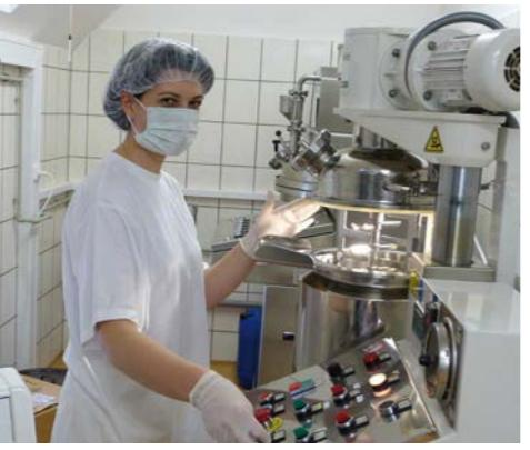
Výroba krémů probíhá ve vakuovém prostředí za nejpřísnějších hygienických podmínek
